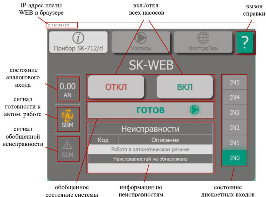
На вкладке «**Насосы**» отображается информация по каждому насосу и осуществляется включение/выключение отдельно каждого насоса в автоматический режим работы. Переключение насосов в ручной режим работы возможно только при помощи органов управления на панели прибора и не допускается через WEB-интерфейс.
